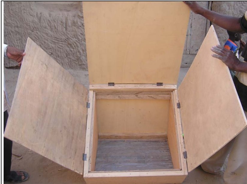
Le four boîte de Tombouctou en cours de construction
