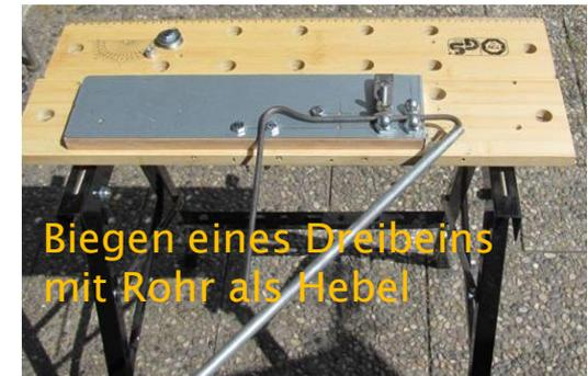
Biegen eines Dreibeins mit Rohr als Hebel
