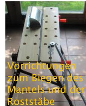
Vorrichtungen zum Biegen des Mantels und der Roststäbe
