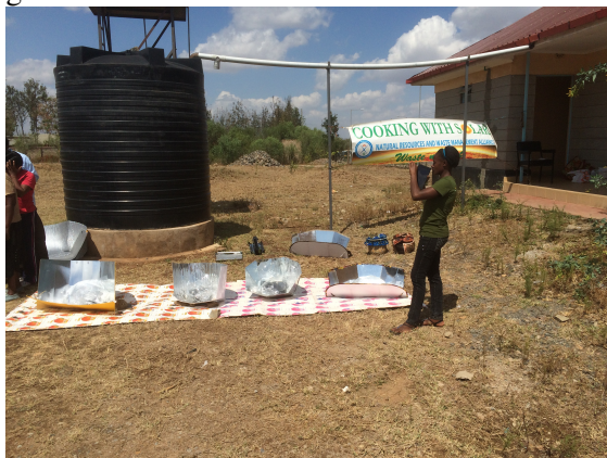
Bild oben, von links nach rechts: LightOven III, Haines Foam, HotPot, CookIt. Etwa 50% Bewölkung während des gesamten Tests.
