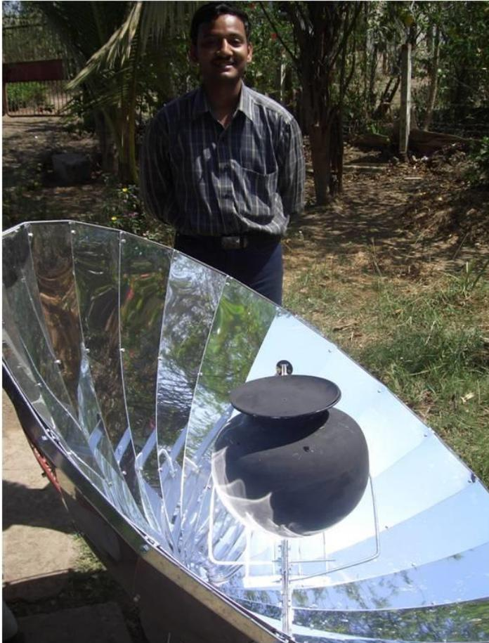
An einem sonnigen Tag können mit dem Parabol-Solarkocher mehr als 40 Liter Wasser abgekocht werden.
