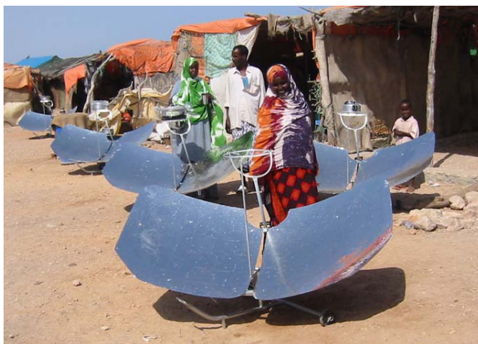
four solaire parabolique chinois, dit « papillon »
