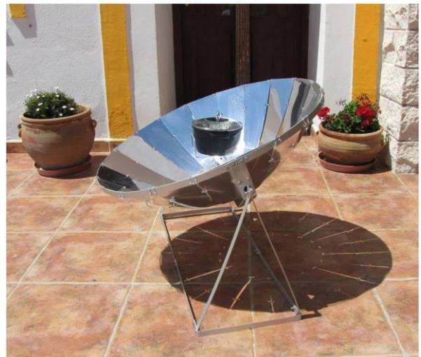
*Foto E12: "Jeder Schüler sollte seinen eigenen Solarkocher bauen". Das wird ermöglicht durch Bausätze. Das Foto zeigt einen Versuchskocher mit 0,8 m Reflektordurchmesser (Test-ESCOLAR 8)*
