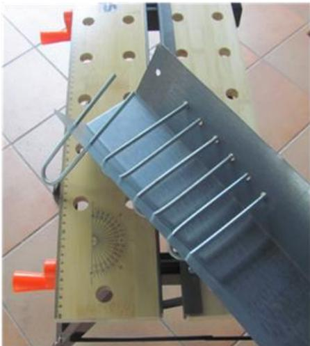
Foto 4.3: Aschepfanne mit eingebautem Rost aus Haarnadel-förmig gebogenen Roststäben
